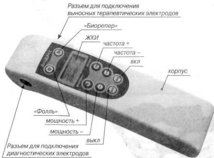
Рис. 2. Внешний вид лицевой стороны аппарата ДиаДЭНС-ДТ (регистрационное удостоверение МЗРФ №29/23030902/5391-03 от 26.06.2003 г.)
